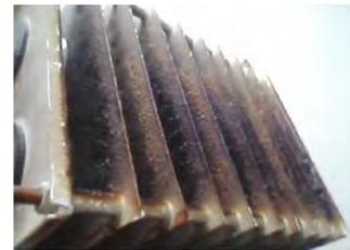
Os módulos eletrostáticos são constituído de um grupo de lamina (positiva e negativa) de material nobre que ao energizar libera trilhões de ions negativos, atuando na quebra das moléculas de gordura as polarizando, e por meio do princípio da estática e da atração de cargas eletricamente opostas os particulados graxos são atraídos para as
