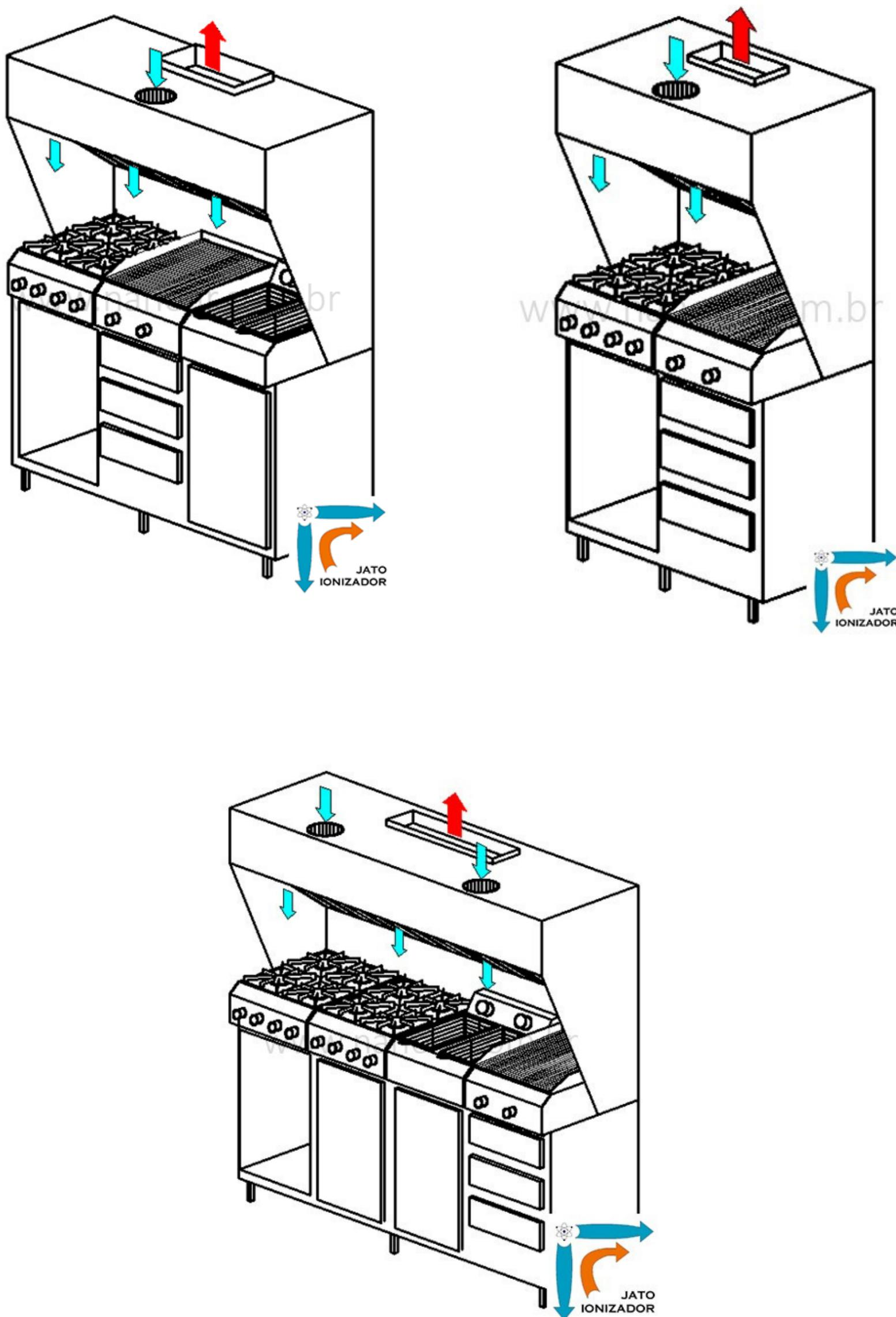
O filtro eletrostático eletro ionizador transforma moléculas gasosas em impurezas sólidas através da atração de cargas elétricas opostas, queimando as impurezas retidas nas lâminas dos módulos filtrantes.
