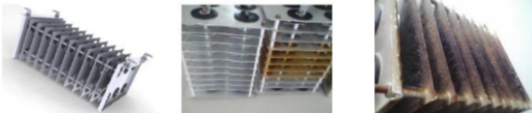
Os módulos eletrostáticos são constituído de um grupo de laminas (positiva e negativa) de material nobre que ao energizar libera trilhões de ions negativos, atuando na quebra das moléculas de gordura as polarizando, e por meio do princípio da estática e da atração de cargas eletricamente opostas os particulados graxos são atraídos para as laminas positivas devolvendo ao ambiente ar ionizado, livre de odores, vírus e bactérias conforme ilustrado na figura abaixo.
