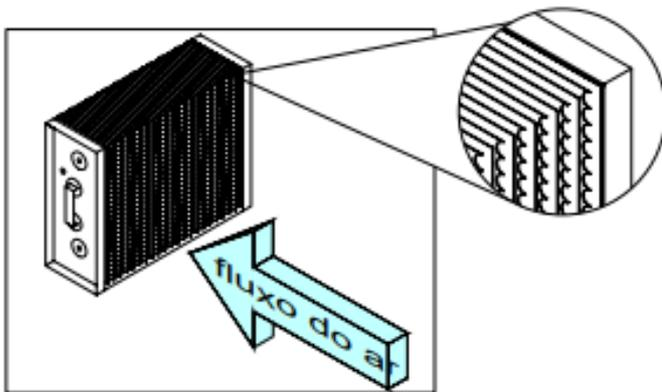
9- Módulos para reposição. Para manter o equipamento em funcionamento durante este período de limpeza, é necessário manter a disposição um conjunto de filtros reservas para reposição
